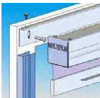
Schraubmontage auf dem Rahmen
