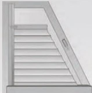
Rollo mit Geometrieführung und eingeschweißtem Stab
