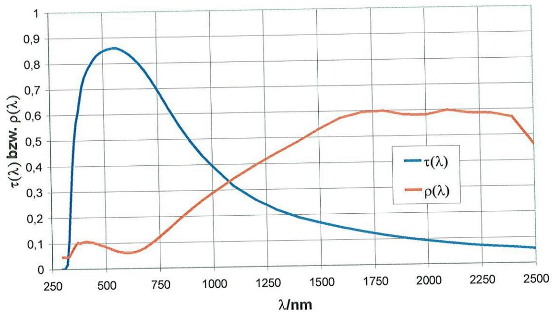
Bild 4: Spektraler Transmissionsgrad  $\tau(\lambda)$  bei senkrechtem Lichteinfall und spektraler Reflexionsgrad  $\rho(\lambda)$  von Isolierglas CLIMAPLUS V 1,1 N bei Lichteinfall von außen (auf Planitherm Futur N) unter  $8^\circ$
