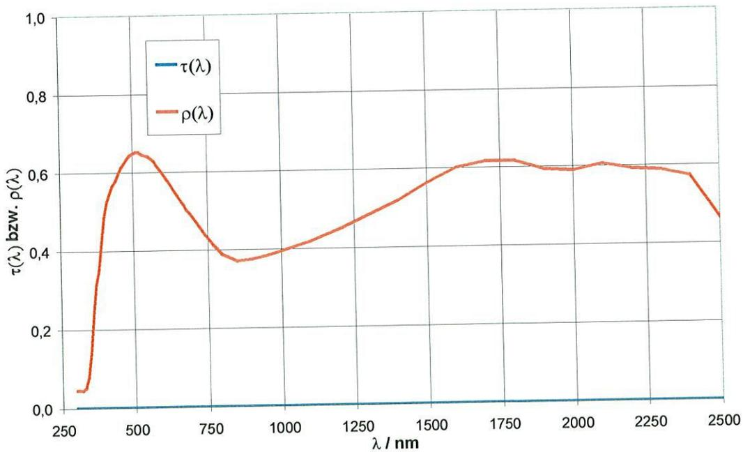
Bild 6: Spektraler Transmissionsgrad  $\tau(\lambda)$  bei senkrechtem Lichteinfall und spektraler Reflexionsgrad  $\rho(\lambda)$  der Kombination Isolierglas CLIMAPLUS V 1,1 N + Folie SiBk002 bei Lichteinfall von außen unter  $8^\circ$
