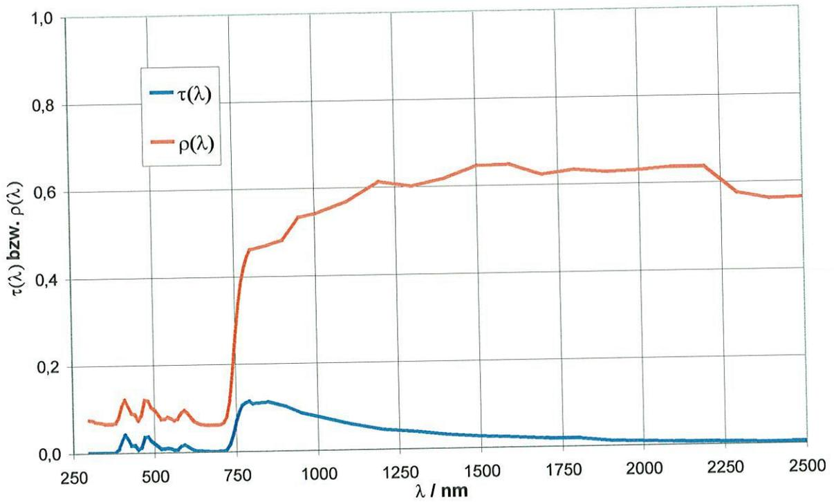
Bild 5: Spektraler Transmissionsgrad  $\tau(\lambda)$  bei senkrechtem Lichteinfall und spektraler Reflexionsgrad  $\rho(\lambda)$  der Kombination Isolierglas CLIMAPLUS V 1,1 N + Folie GyGy033 bei Lichteinfall von außen unter  $8^\circ$
