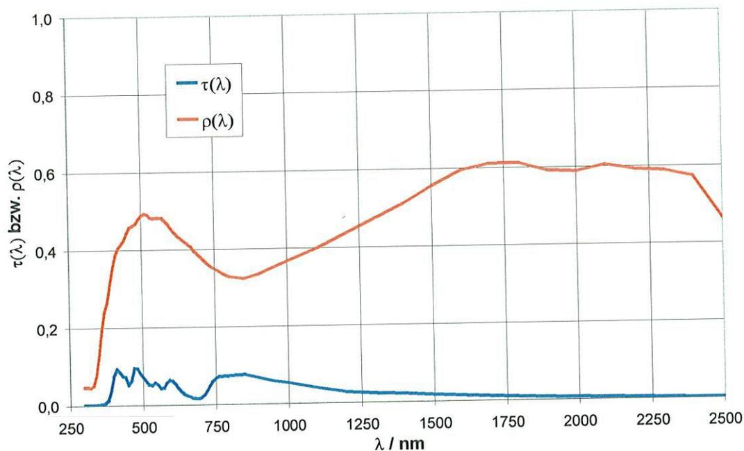
Bild 7: Spektraler Transmissionsgrad  $\tau(\lambda)$  bei senkrechtem Lichteinfall und spektraler Reflexionsgrad  $\rho(\lambda)$  der Kombination Isolierglas CLIMAPLUS V 1,1 N + Folie SiAt072 bei Lichteinfall von außen unter  $8^\circ$
