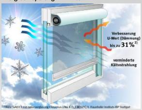
In der kühlen Jahreszeit helfen die Rollos Heizenergie sparen, indem sie die Dämmeigenschaft der Verglasung um bis zu 31 % verbessern. Die Aluminiumbeschichtung reflektiert die Wärme in den Raum zurück und zwischen Behang und Fenster entsteht ein dämmendes Luftpolster.
